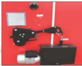
Kotovi snage 40 i 60kW opremljeni su el. pogonom "Belimo" za okretanje doboša na kome sagoreva ogrev. Kotlovi od 100-450kW opremljeni su mehanizmom sa el. motorom snage 90W za okretanje doboša. Otvori za kontrolu plamena nalazi se sa bočne strane. Otvor za potpaljivanje kotla je sa prednje strane. Otvor za ulaz svežeg vazduha je sa bočne strane.
