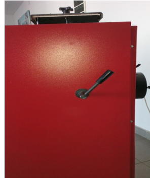
Sl.8. Položaj ručice klapne kotla pri radu kotla (radni položaj)
